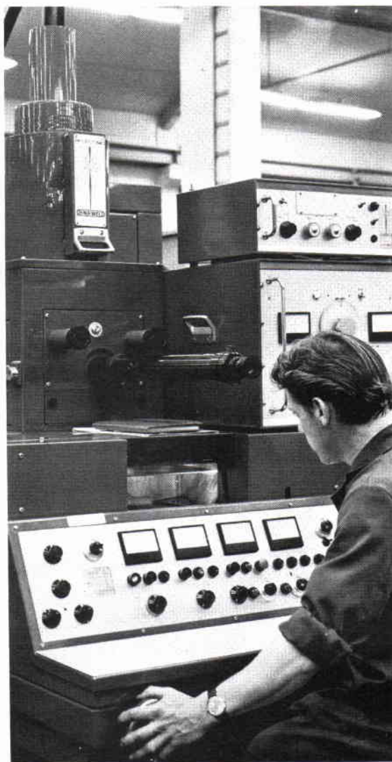
Elektronsvetsaggregatet som accelererar elektronerna till 150.000 km/sek med en svetsstråle bara 0,1 mm tjock.
